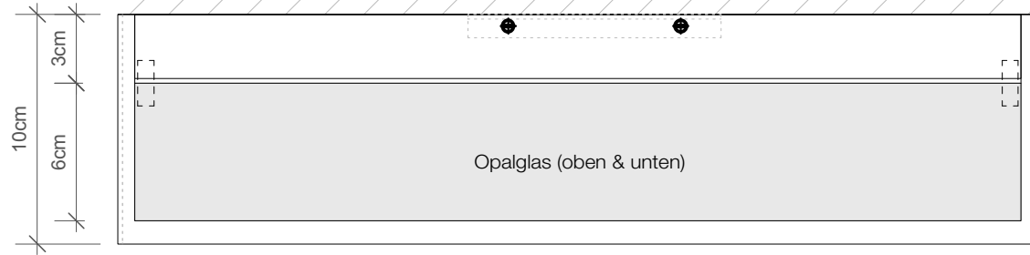
Draufsicht Wandmontage Top view wall fastening
